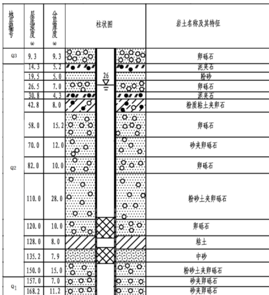
图 3.1-7 Zk308 孔地质柱状图
